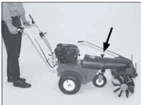
1. Вы можете идеально отрегулировать давление щетки при помощи поддерживающего колеса
