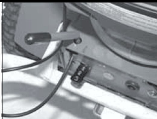
1. Рычаг переключения передач вверх : 1я передача – медленно
