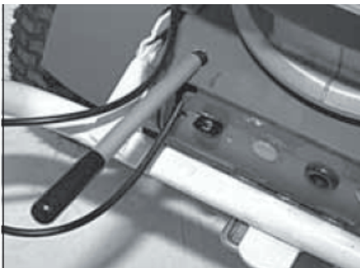
3. Рычаг переключения передач вниз: 3я передача – быстро.
