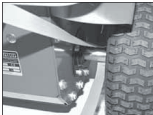
4. Используйте заднюю ось как точку фиксации.
