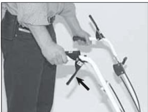
1) Данный рычаг задействует заднюю передачу.
