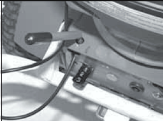
1. Рычаг переключения передач вверх : 1я передача – медленно
